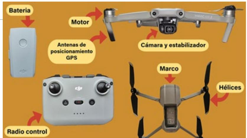
Figura 7. Componentes de un dron multirrotores. Fuente: elaboración propia con el software Adobe Express (<https://www.adobe.com/es/express/>).
